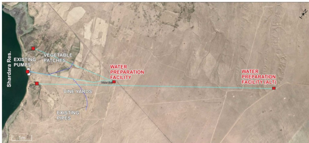
Рисунок 3: Концептуальная схема Жаушыкумской системы капельного орошения с альтернативным местоположением компонентов и существующей ирригационной инфраструктурой и сельскохозяйственными угодьями.
